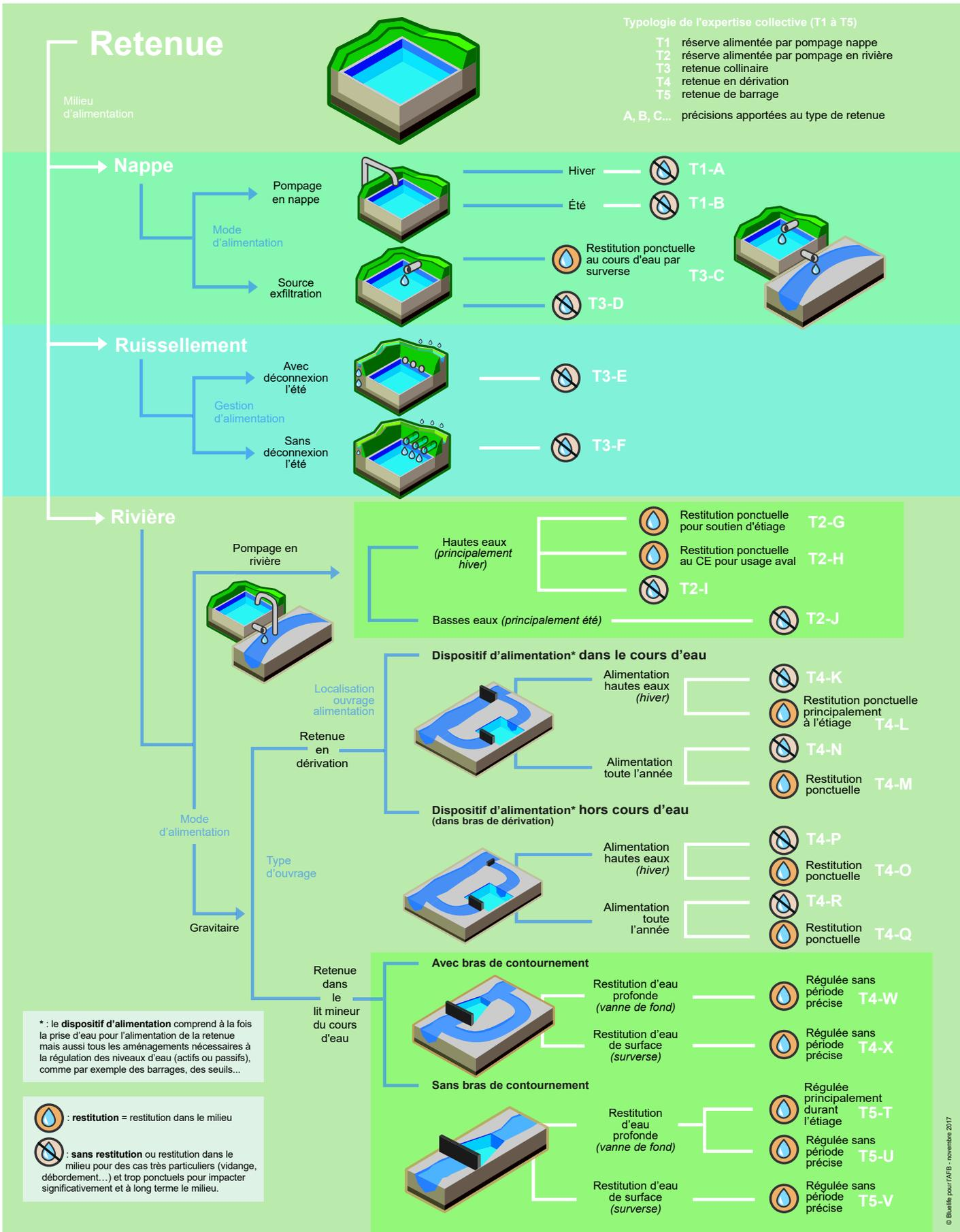
Figure 2. Typologie des retenues (23 types, par ex. T1-A) proposée dans le rapport méthodologique, à l'issue des séminaires. Cette typologie précise celle établie par l'expertise collective (T1 à T5).
