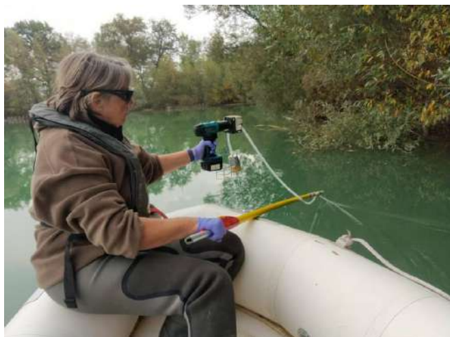
Figure 14 : Pompage et fixation par un tampon du support filtre
