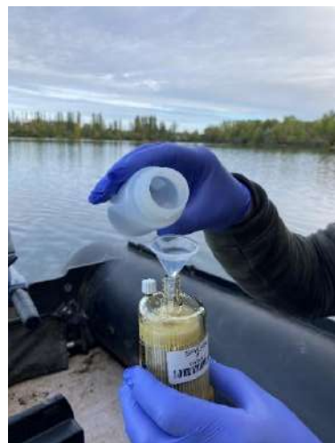
Figure 14 : Pompage et fixation par un tampon du support filtre
