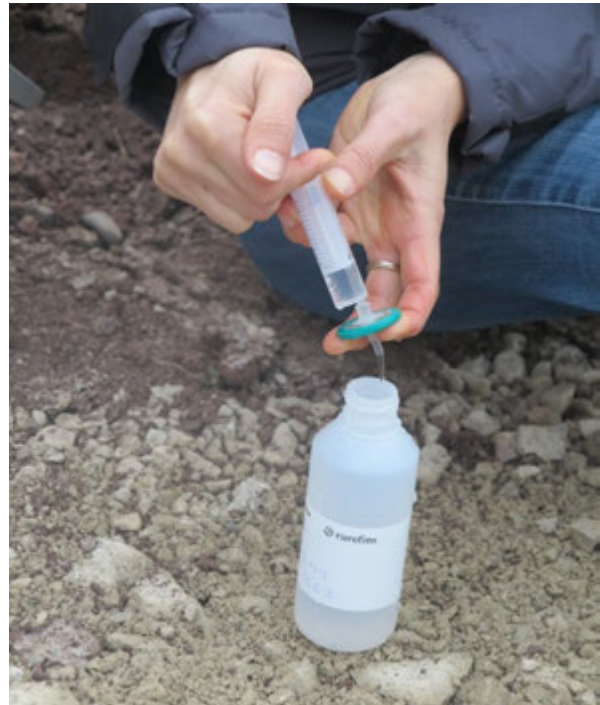
Photographie 34 – Filtration des eaux
