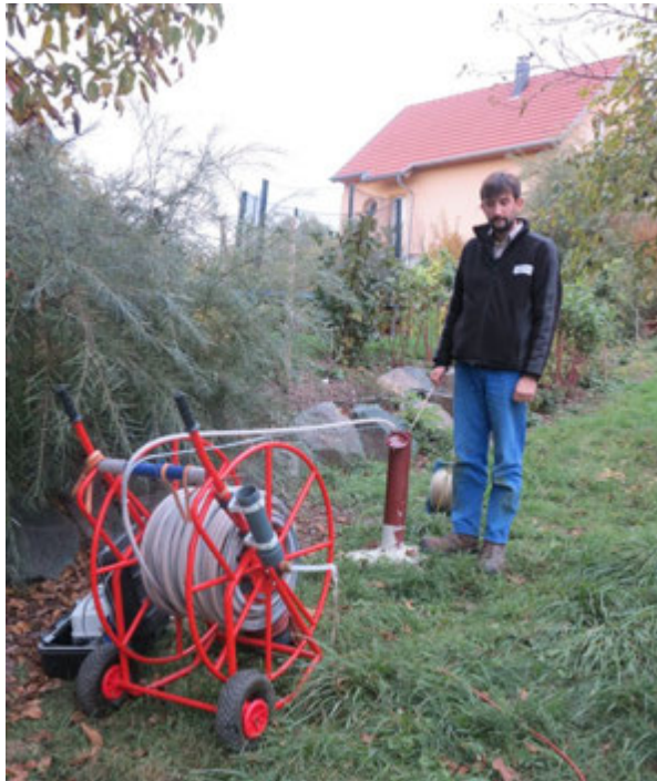
Photographie 33 – Dispositif de prélèvement sur le forage SC6-2
