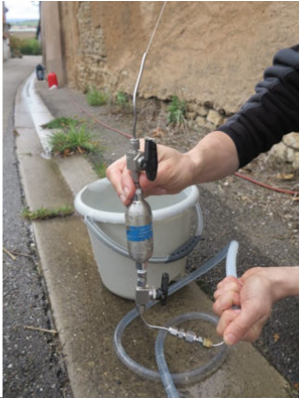
Photographie 43 – Prélèvements pour analyses de gaz dissous (puits communal)
