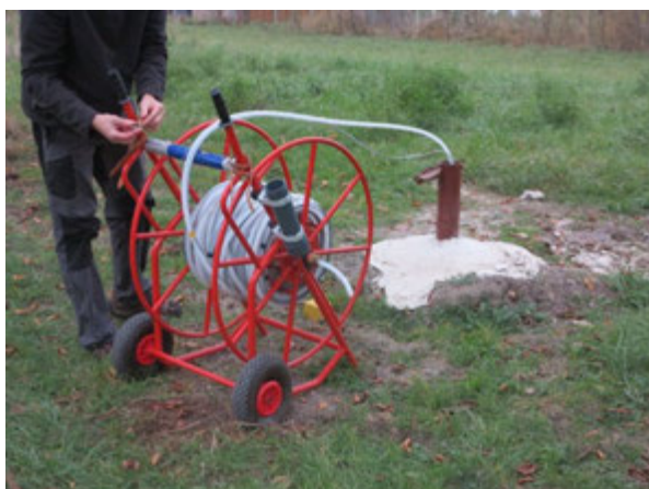
Photographie 37 – Dispositif de prélèvement sur le forage SC7
