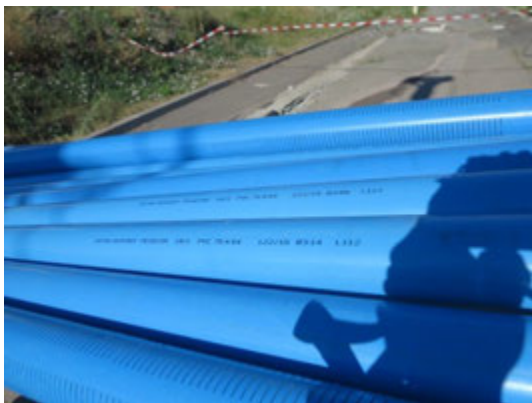
Photographie 3 – Tubes crépinés en PVC
