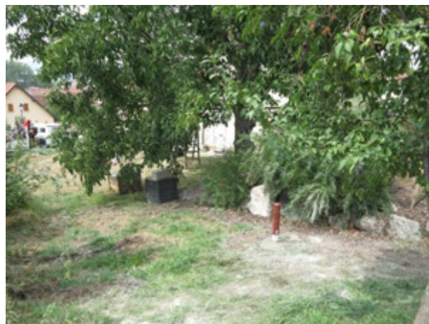
Photographie 24 – Vue du piézomètre SC6-2 terminé
