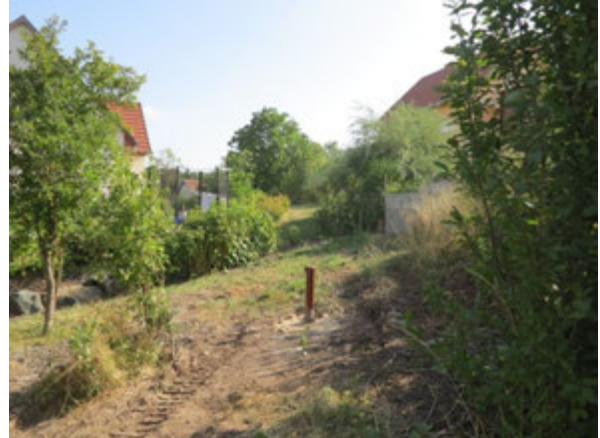
Photographie 18 – Vue du piézomètre SC6 terminé
