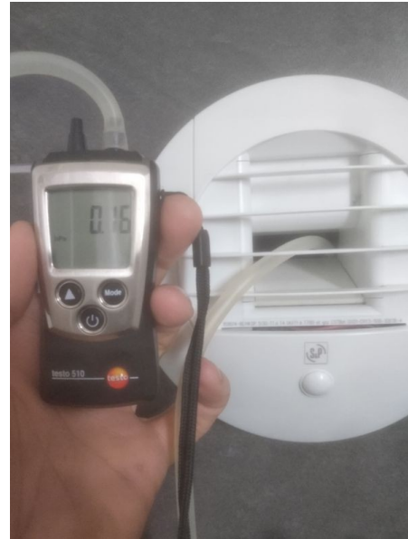
Obstruction partielle sur sortie d'air
