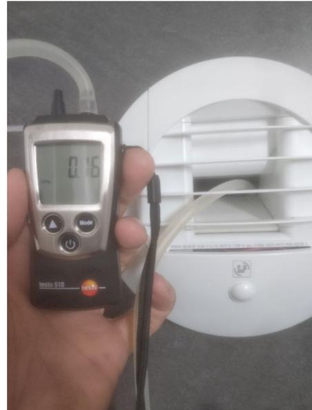
*Mesure d'un débit d'air insuffisant sur une bouche VMC*
