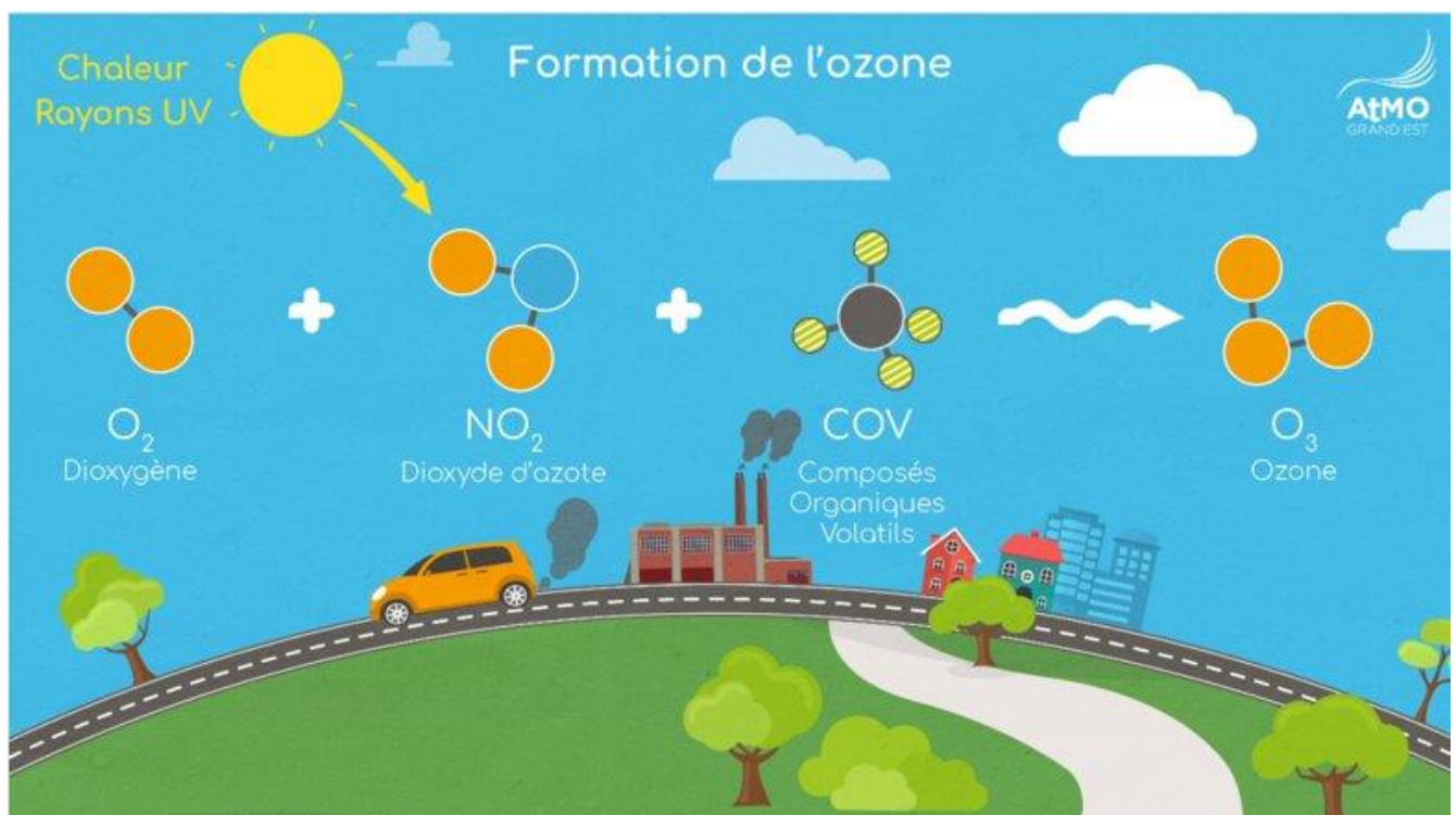
Figure 136 : Schéma représentant les sources des précurseurs de l'ozone et la réaction chimique de sa formation.
