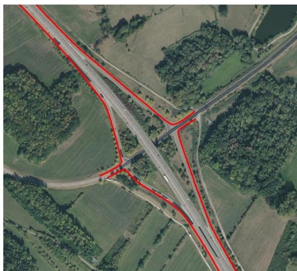
**Figure 39** : Exemple d'implantation des clôtures au droit d'un échangeur afin de limiter l'accès aux emprises pour la faune (Source : Guide passage à faune ; Cerema, 2021)
