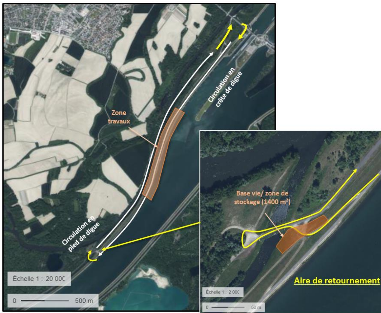
Figure 6- Accès, circulation et aménagements travaux
