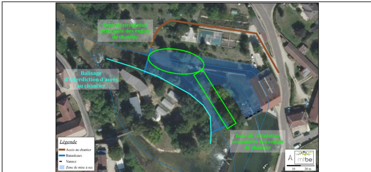
Figure 13 : Zones de circulation des engins de chantier et balisage proposé.
