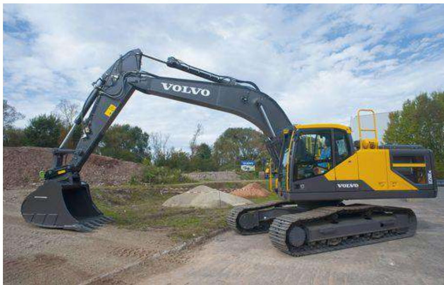
Pelle mécanique de 25 tonnes sur chenille
