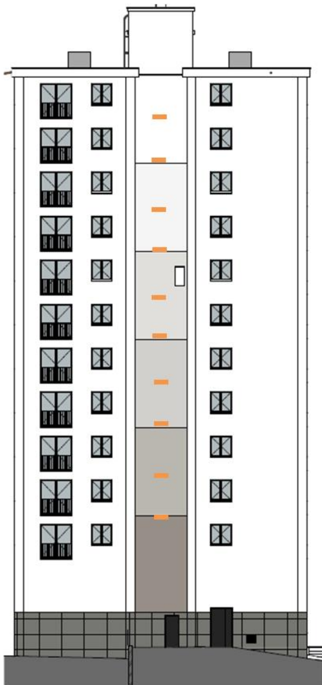
FIGURE 14 : LOCALISATION DES 10 GITES DE TYPE 2FE (EN ORANGE) SUR LA FAÇADE OUEST DU BATIMENT DES FIGUIERS.
