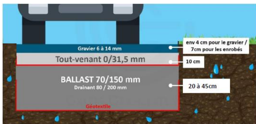
Figure 13: Composition privilégiée des pistes internes et des plateformes de poste
