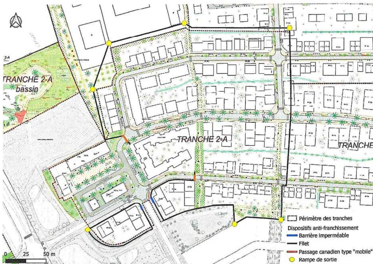
Figure 23 : Périmètres de mise en place du filet et localisation des rampes de sorties associées.
