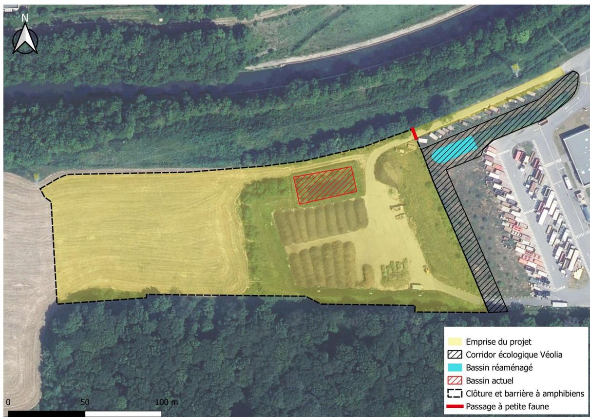
Figure 18 : Localisation de la clôture/barrière à amphibiens et du passage à petite faune.
