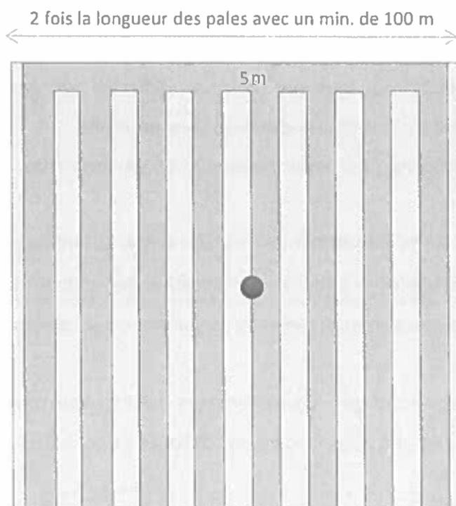
Figure 3 : Méthodologie de prospection au pied des éoliennes
