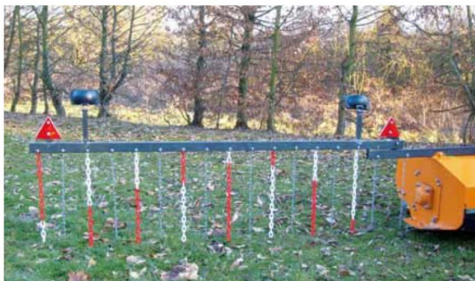
Figure 65. Exemple de barre d'effarouchement (extrait du Faune sauvage n° 291, Machinisme agricole et faune sauvage)
