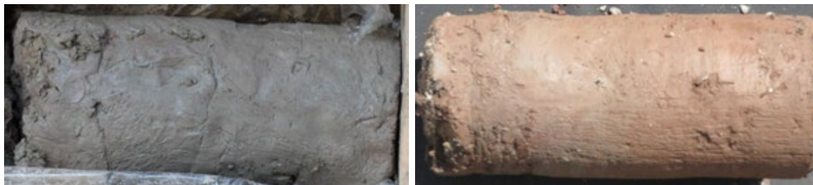
Figure 14 – Echantillon de terrains argileux plastiques (échantillon SC4-2 vers 3,5 m à droite, et SC7-12 vers 32 m à droite)
