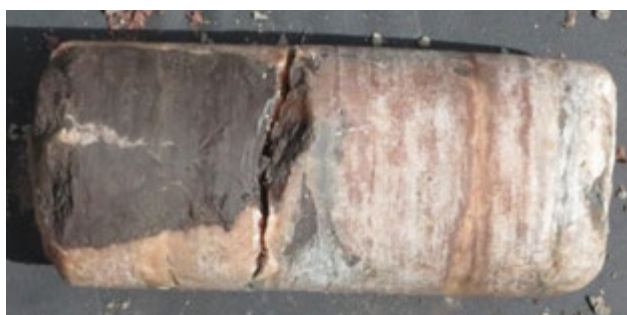
Figure 27 – Echantillon SC7-16 (morceau du banc bréchique ayant servi aux corrélations) : 47% d'anhydrite et 15% de gypse
