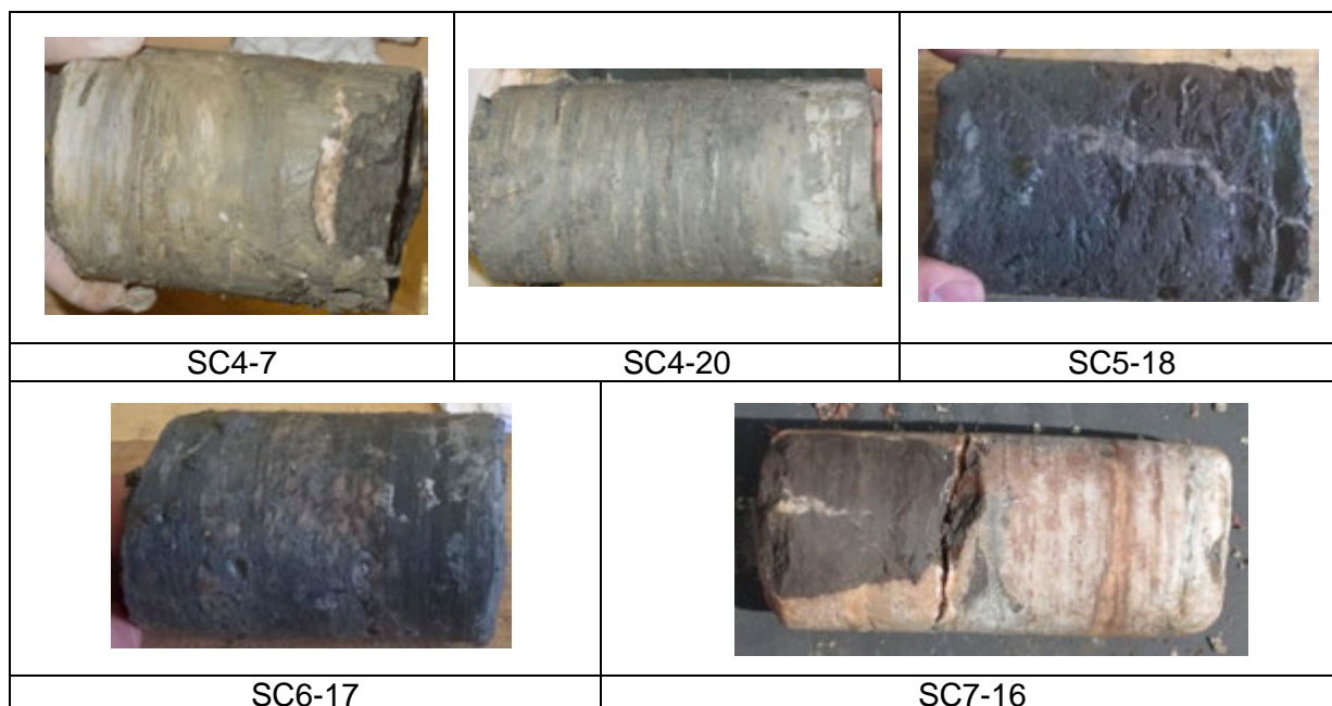
Figure 44 – Photographies des échantillons soumis aux essais œdométriques (avant essais)
