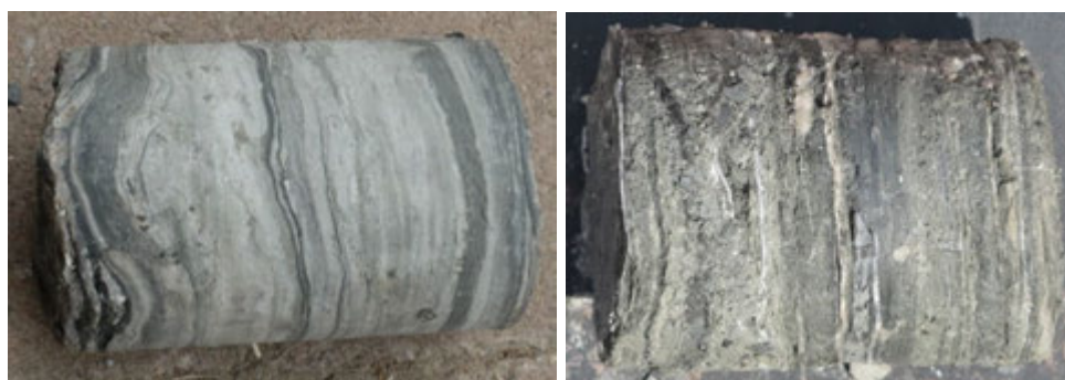
Figure 15 – Exemple de terrains très compacts à tendance dolomitique à gauche (échantillon SC4-15 vers 21 m) et de terrains finement laminés qui se délitent plus facilement à droite (échantillon SC6-14 vers 32 m)
