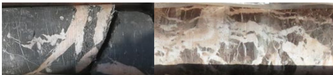
Figure 16 – Exemple de fractures à ouverture pluricentimétrique et à remplissage évaporitique (à gauche SC4 vers 37 m, à droite SC7 vers 40 m)
