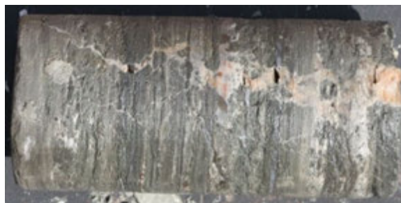
Figure 26 – Echantillon SC6-10 (morceau du banc bréchique ayant servi aux corrélations) : 74% d'anhydrite et 11% de gypse
