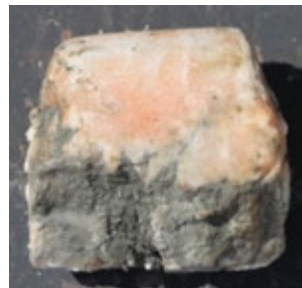
Figure 25 – Echantillon SC5-11 (morceau du banc bréchique ayant servi aux corrélations) : 83% de gypse
