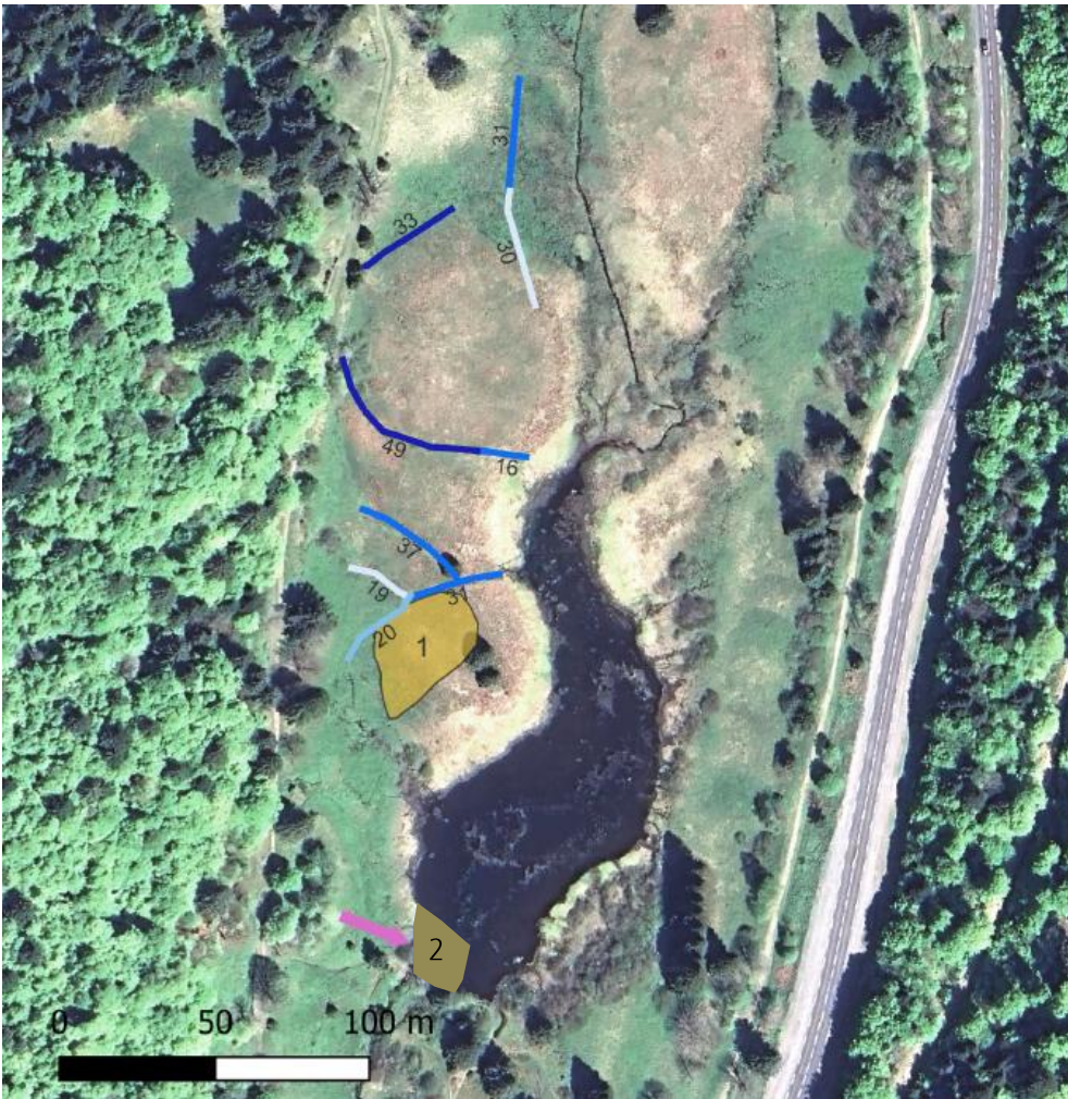
Figure 11 : Localisation de la zone d'étrépage (1) envisagée, les fossés drainants à remblayer avec leur longueur, et la zone de déversement des excédents au sein de la pièce d'eau (flèche rose et 2)
