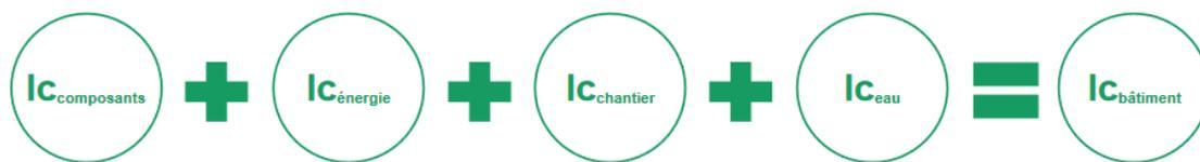
Figure 2: Calcul de l'indicateur carbone bâtiment
