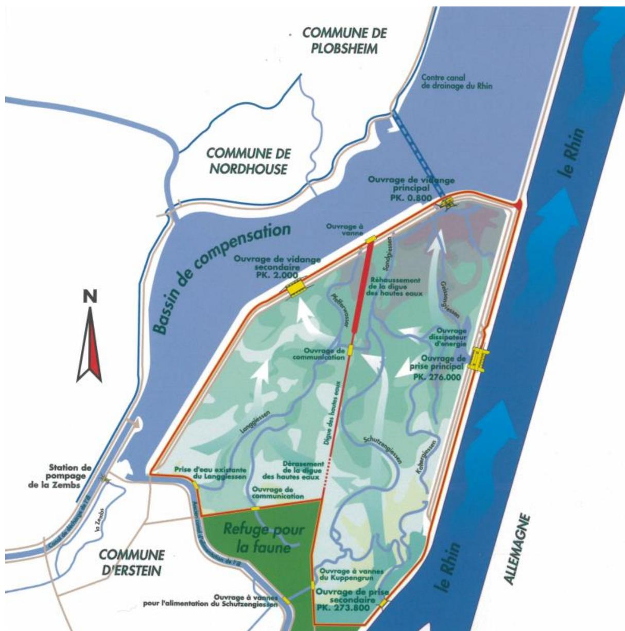
Figure 5 : Fonctionnement global du polder d'Erstein en cas de crue du Rhin
