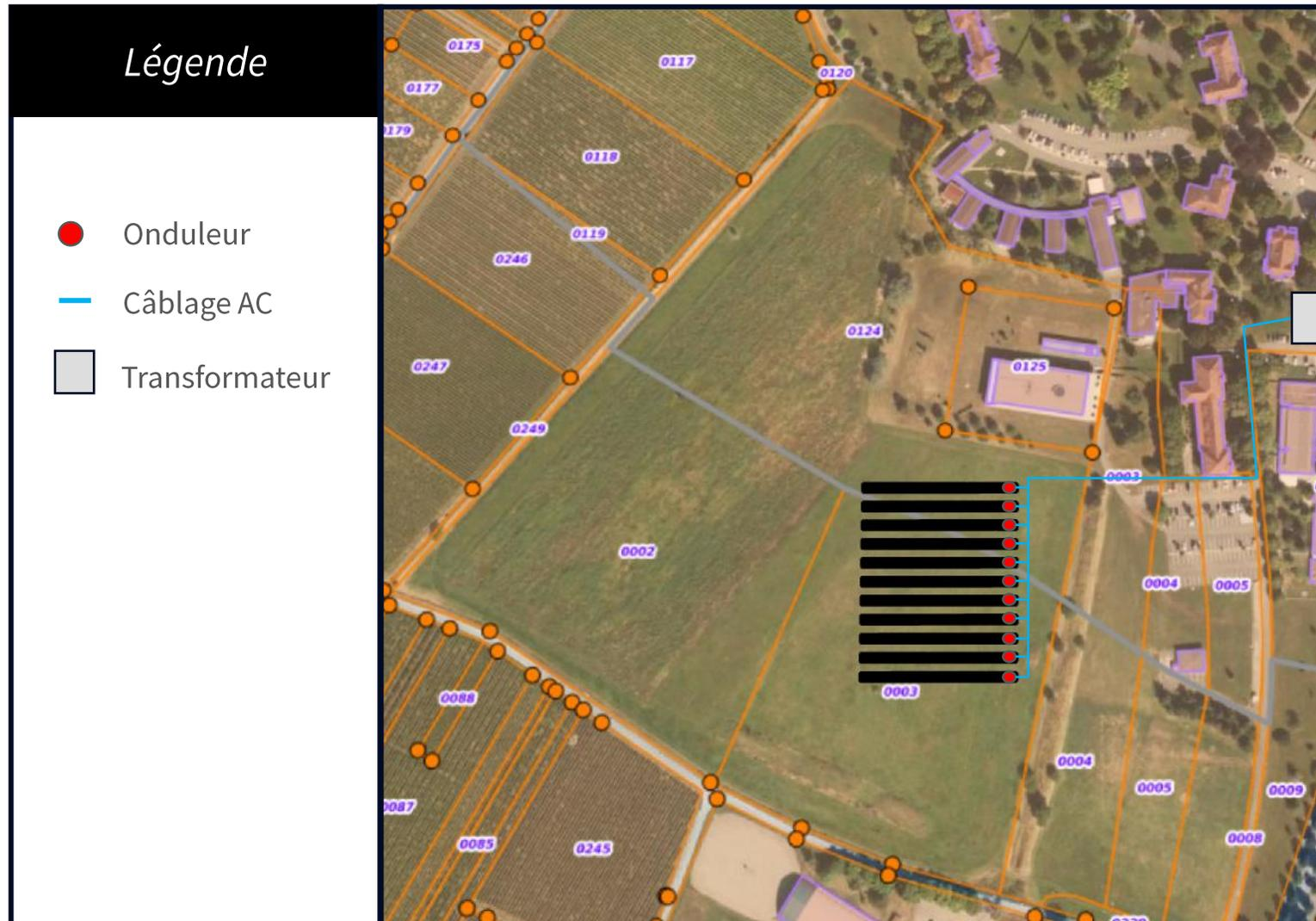
Dans ce scénario, la centrale est raccordée à un transformateur qui injecte la production photovoltaïque sur le réseau interne de l'hôpital pour autoconsommer l'énergie.
