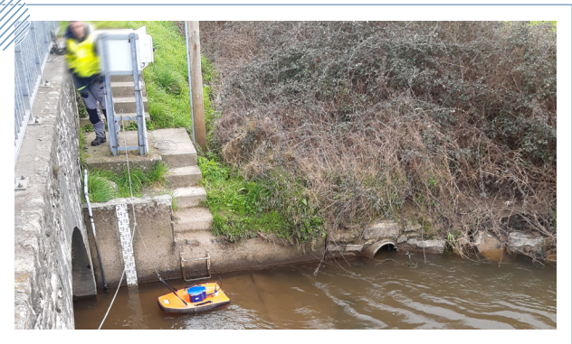
Jaugeage à l’aDcp (acoustic Doppler current profiler) sur planche
