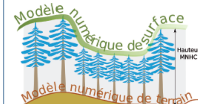
Figure 4 - La différence entre le modèle numérique de surface et le modèle numérique de terrain permet d'obtenir le modèle numérique de hauteur de canopée (MNHC) qui décrit la hauteur des arbres.
