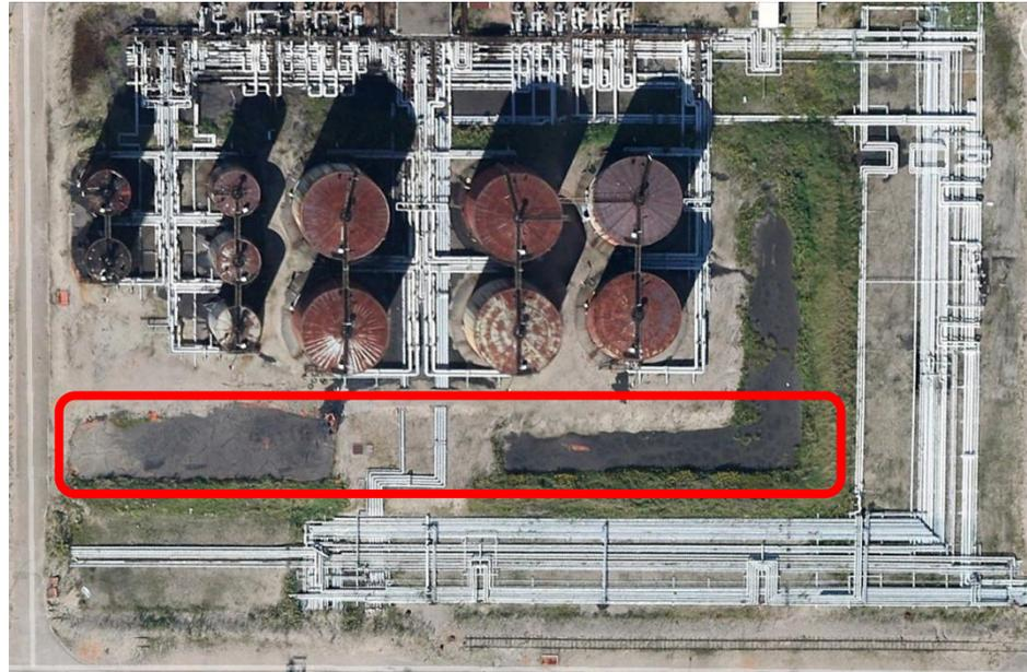
Un première phase de travaux a consisté à l'excavation de 723 tonnes de matériaux répartis comme suit : 403 tonnes de bitume solidifié répandu dans deux anciennes lagunes et 320 tonnes de matériaux très enrobés par du bitume ( cf. photo ci-dessus) .
