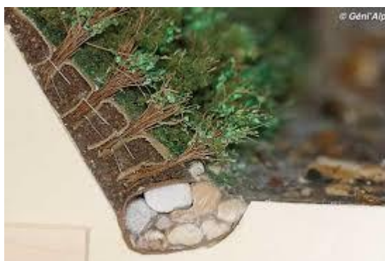
Figure 18-Principe illustré de lits de plants et plançons et enrochements en pied (source: Géni'Alp)
