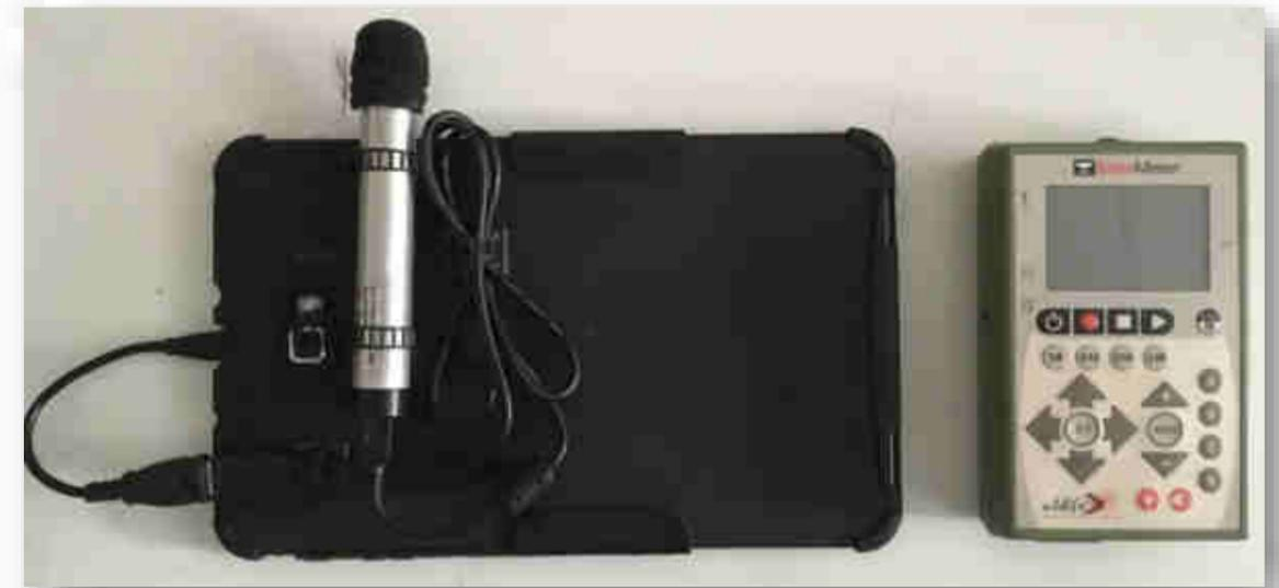
Tablette A9 relié à un micro Dodotronic modèle Ultramic UM250k et détecteur actif EchoMeter 3
