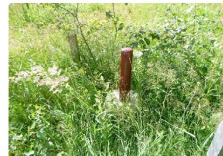
Photographie du piézomètre PZ3 (X 1047445 – Y 6854232).
