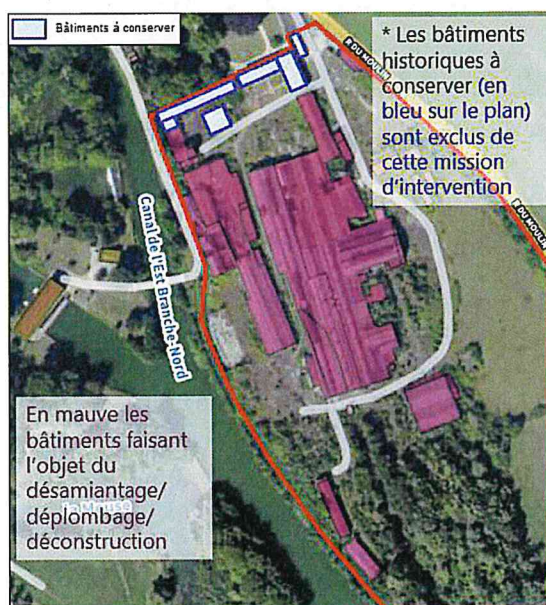
Cartographie des bâtiments conservés ou non dans le cadre des travaux de l'ancienne fonderie LFE de Stenay (Source : BEREST)
