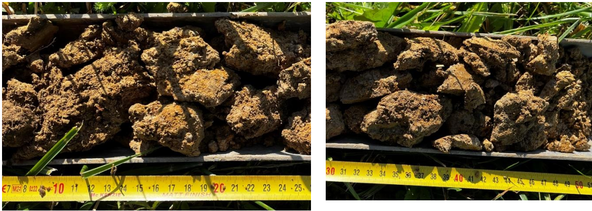
Figure 31 : Photos du sondage n°5, avec traces d'hydromorphie
