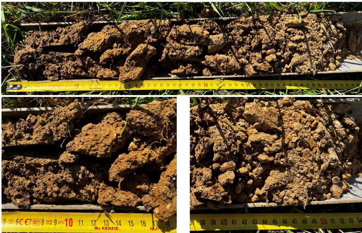
Figure 29 : Photos du sondage n°3, avec traces d'hydromorphie
