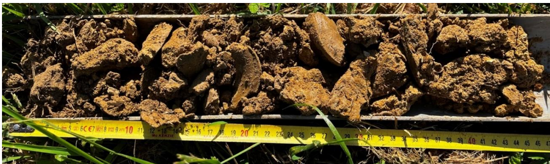
Figure 28 : Photos du sondage n°2, avec traces d'hydromorphie
