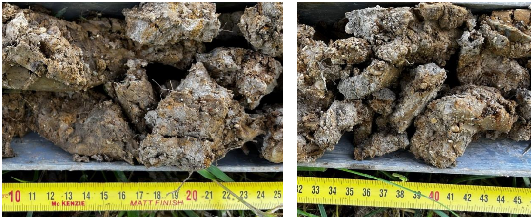
Figure 33 : Photos du sondage n°7, avec traces d'hydromorphie
