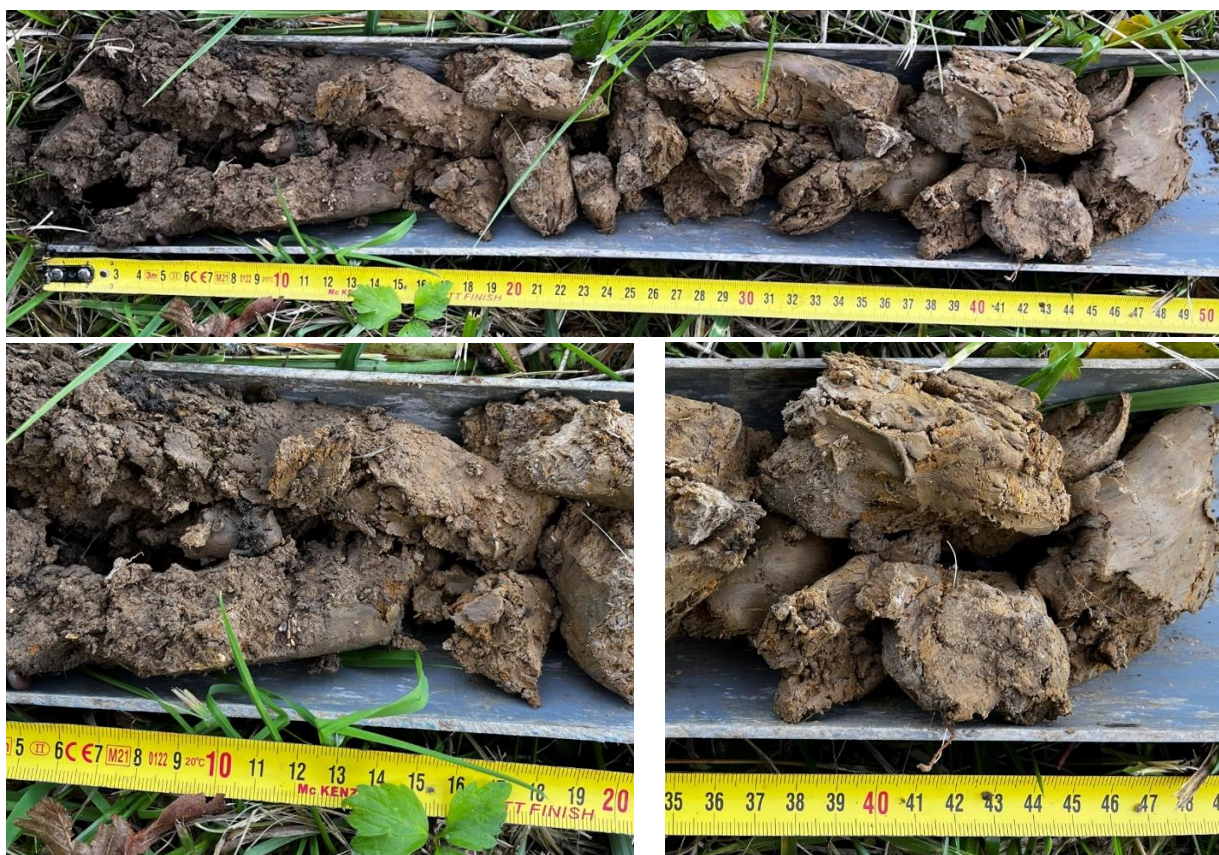
Figure 33 : Photos du sondage n°7, avec traces d'hydromorphie
