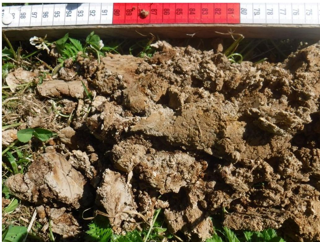
Figure 20. Traits rédoxiques (taches de couleur rouille) et traits réductiques (taches grises) présents sur le sondage n°12
