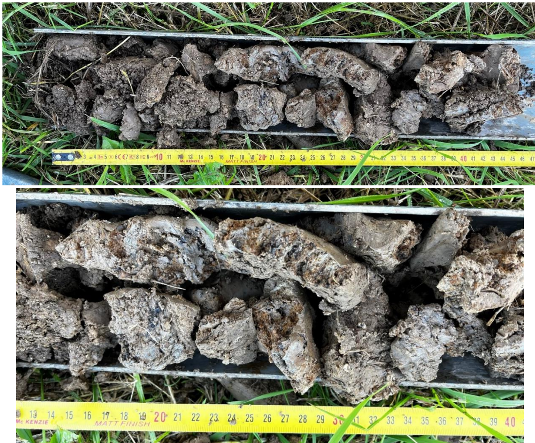
Figure 27 : Photos du sondage n°1, avec traces d'hydromorphie
