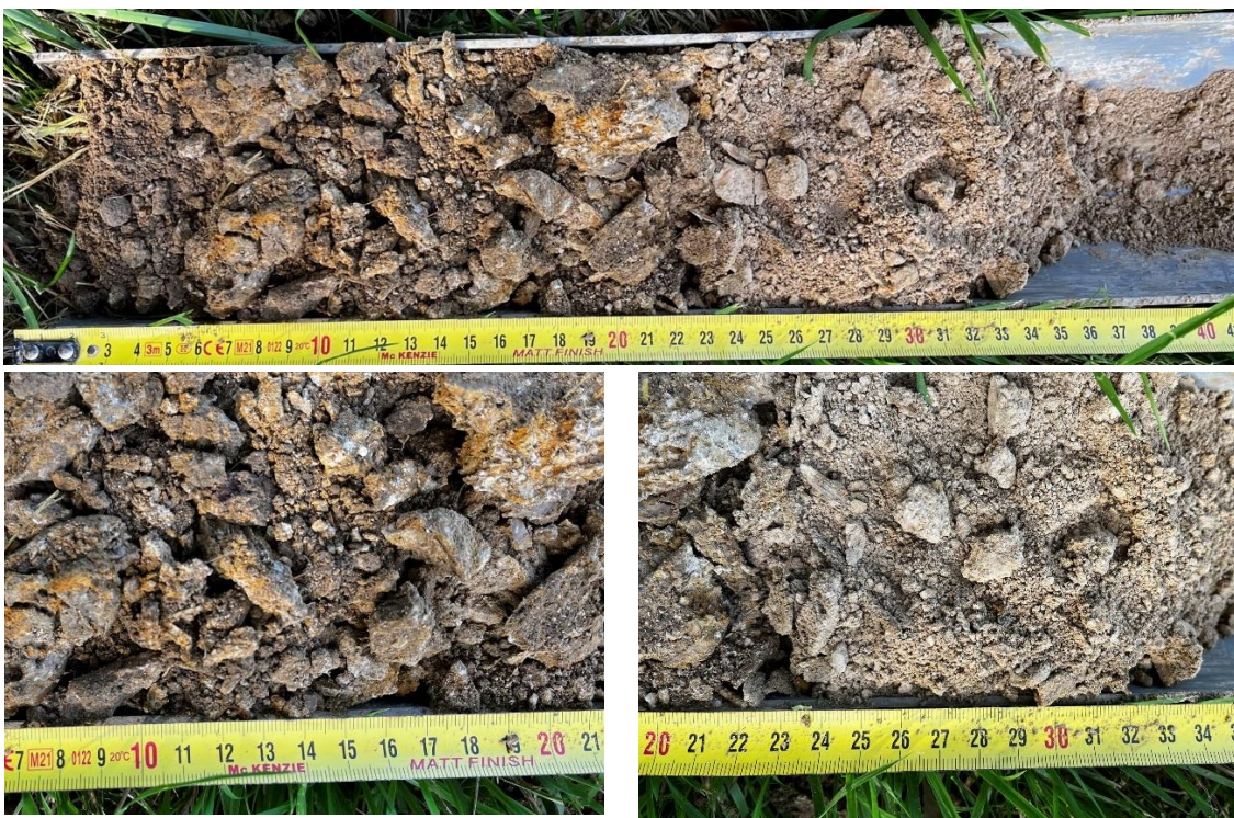
Figure 35 : Photos du sondage n°9, avec traces d'hydromorphie
