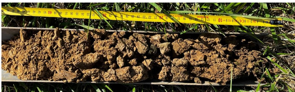
Figure 34 : Photos du sondage n°8, avec traces d'hydromorphie
