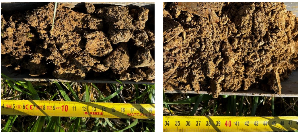
Figure 35 : Photos du sondage n°9, avec traces d'hydromorphie
