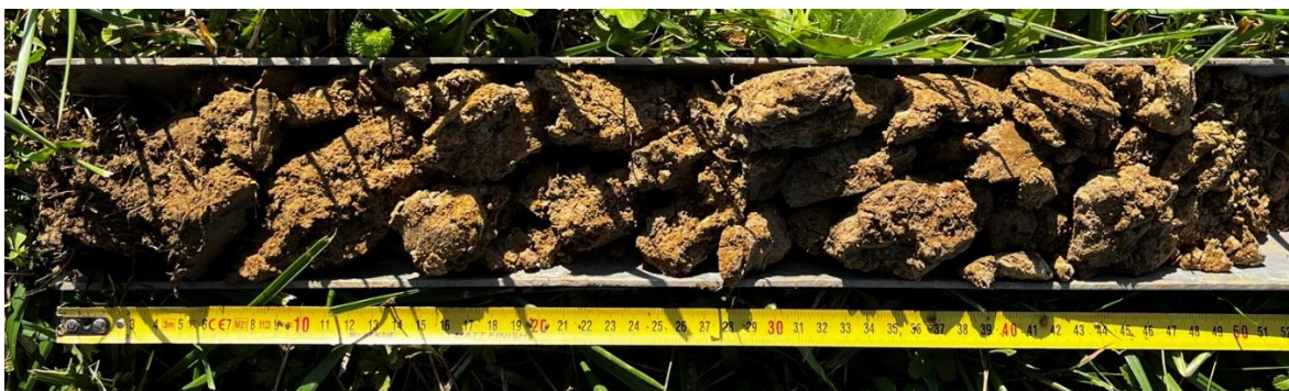
Figure 30 : Photos du sondage n°4, avec traces d'hydromorphie
