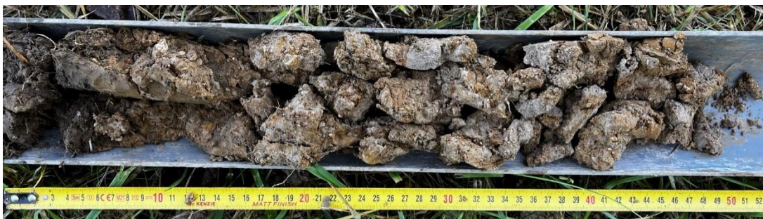
Figure 32 : Photos du sondage n°6, avec traces d'hydromorphie
