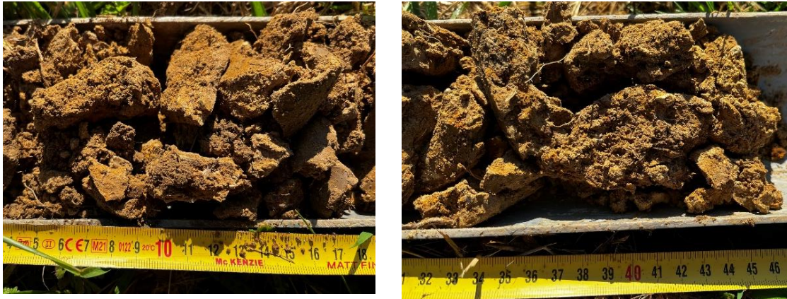
Figure 29 : Photos du sondage n°3, avec traces d'hydromorphie
