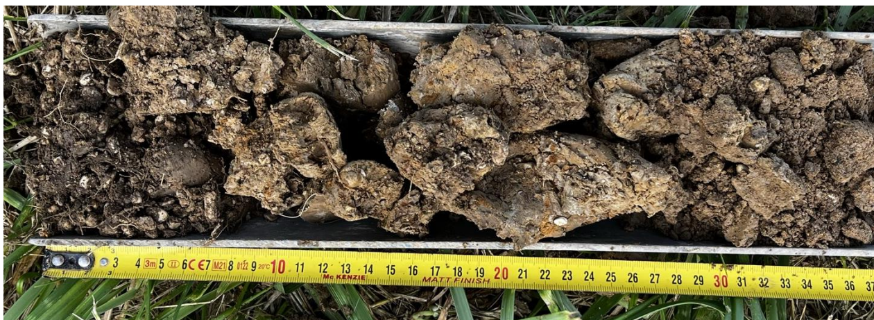
Figure 36 : Photos du sondage n°10, avec traces d'hydromorphie
