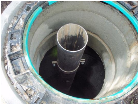
Dispositif de mesure du niveau de remblai sous la dalle à - 10 mètres
