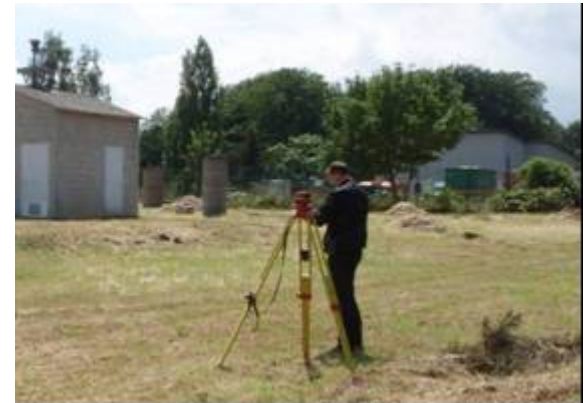
Nivellement des têtes de puits Gargan
