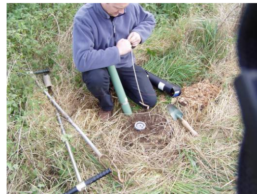
Installation d'une sonde «BARASOL »
