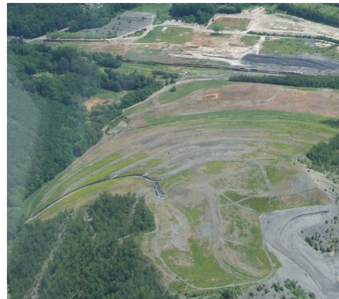
Les banquettes drainantes et la descente d'eau du terril La Houve 2
