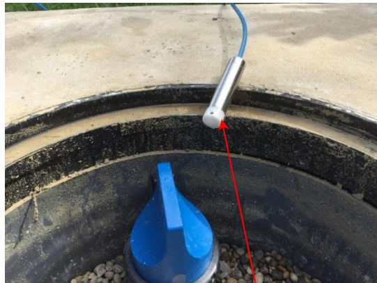
Capteur piézométrique
